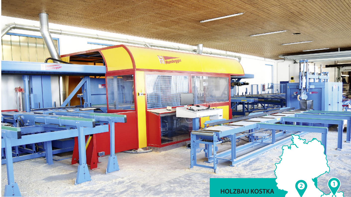
Die brandneue K2-Industry von Hundegger in Kombination mit dem Hobelautomaten HM-3 bei Kostka Holzbau
