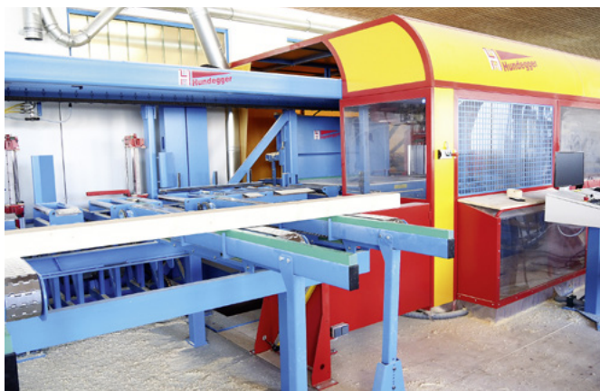
Am Aufgabebereich vor der K2-Industry ist Platz für mehrere Bauteile bis zu 16 m Länge
