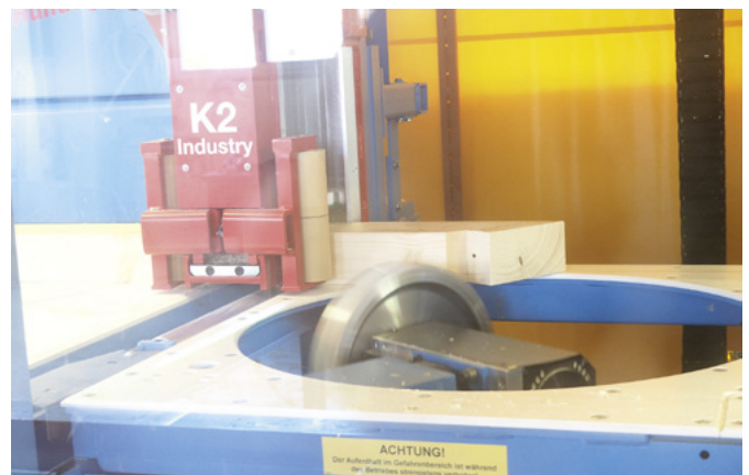
Die K2-Industry erledigt alle Abbundarbeiten in einem Durchgang – wie hier etwa mit der Universalfräse
