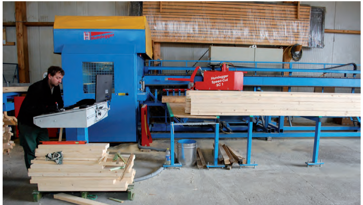
Pliki maszynowe są przesyłane z działu konstrukcyjnego do centrum ciesielskiego Speed-Cut firmy Hundegger.
