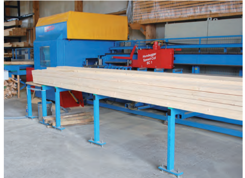
Pliki maszynowe są przesyłane z działu konstrukcyjnego do centrum ciesielskiego Speed-Cut firmy Hundegger.
