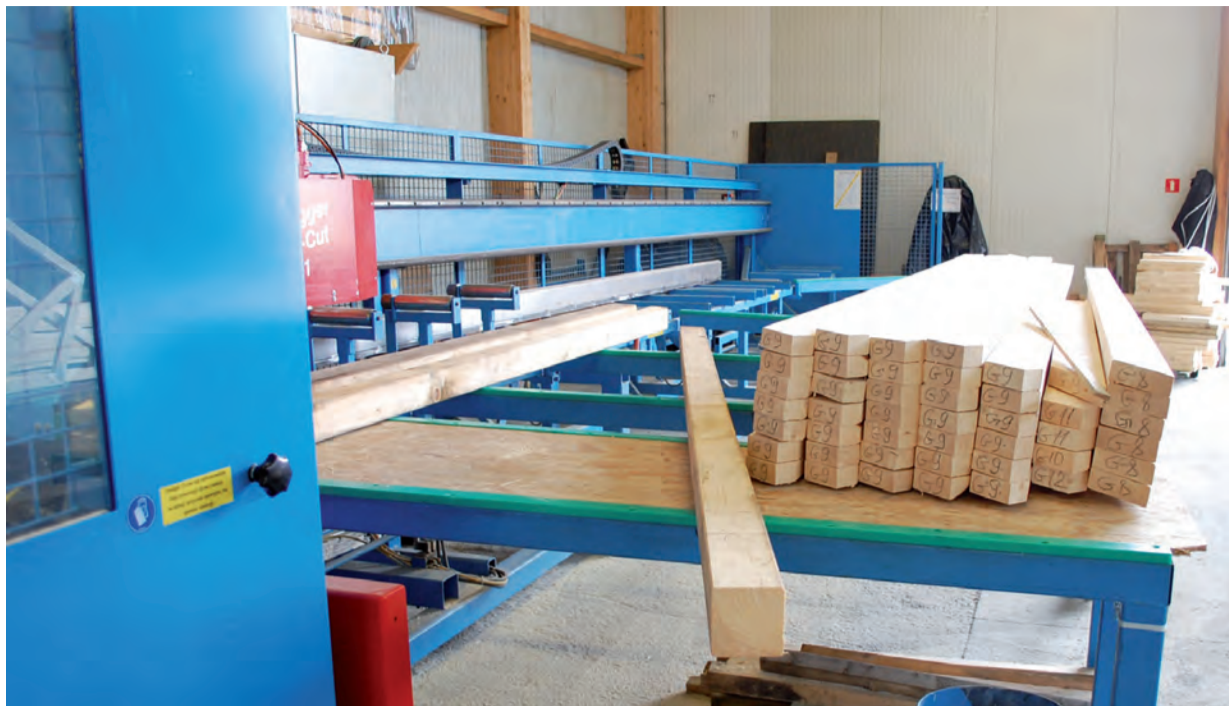
Obrabiany materiał może być podawany i odbierany ręcznie lub za pomocą niezależnie sterowanych systemów transportowych.
