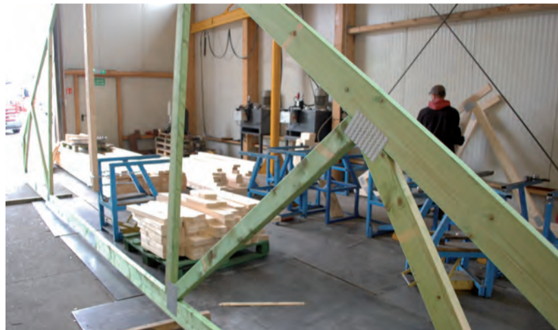
Dzięki technologii MiTek® producent może tworzyć więźary o rozpiętości nawet do 30 m.
