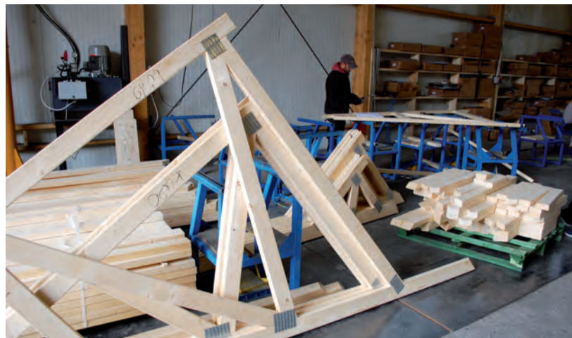
Dzięki technologii MiTek® producent może tworzyć więźary o rozpiętości nawet do 30 m.
