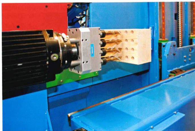
Die ROBOT-Drive eignet sich hervorragend für Holzbaubetriebe. Hier mit Mehrspindelbohrkopf.
