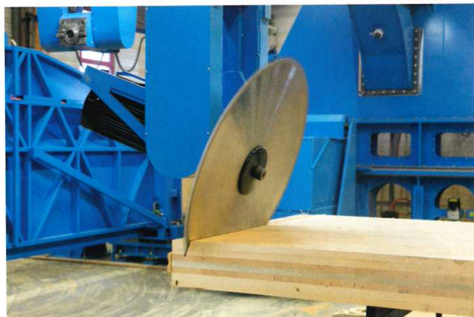
Im Portalbearbeitungszentrum PBA lassen sich Bauteile von bis zu 9 Meter Breite und 48 cm Dicke bearbeiten. Zu sehen ist die Plattensäge.
