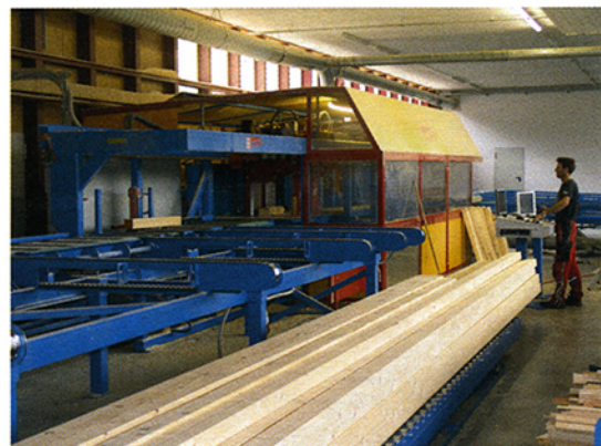
Die neue Abbundmaschine im Einsatz
