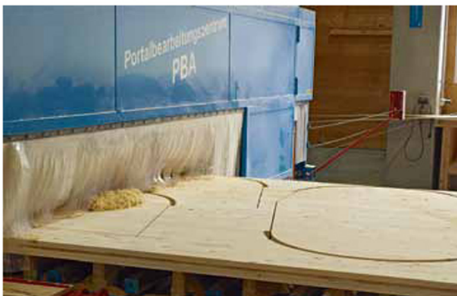
hsbCAD steuert die Portalbearbeitungsanlage mit den verschnittoptimalen Daten direkt an
