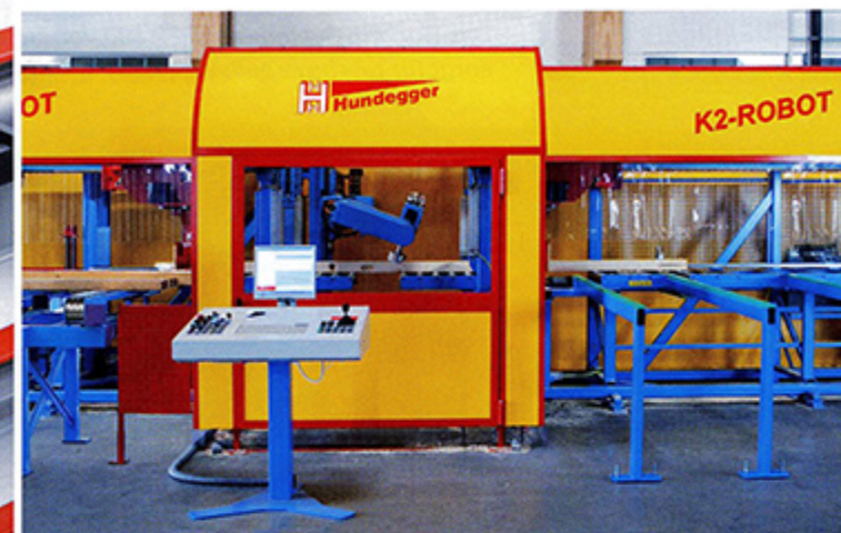
Oben: Die K2 Robot von Hundegger punktet mit der neuen 6-Achsbearbeitung, einem Aggregat mit fünf Freiheitsgraden und einem automatischen Werkzeugwechsler mit 16 Werkzeugplätzen. Links: Serienmässig sind die Striebig CONTROL und EVOLUTION mit einer Alu-Mittelauflage über die gesamte Maschinenlänge ausgestattet. Optional kann eine Mittelauflage aus High-Tech-Kunststoffmaterial nachgerüstet werden.
