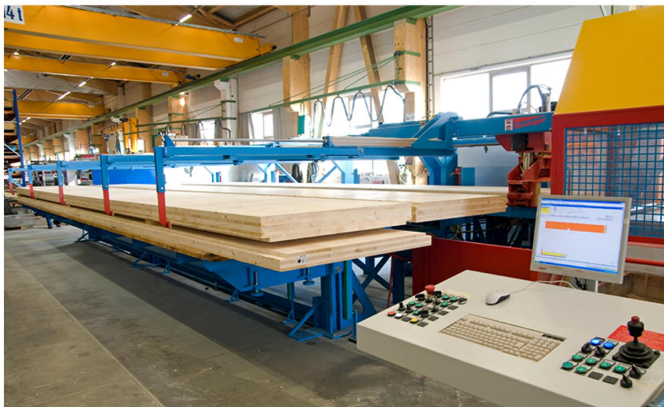
Vollautomatische Abbundmaschine von Hans Hundegger.
