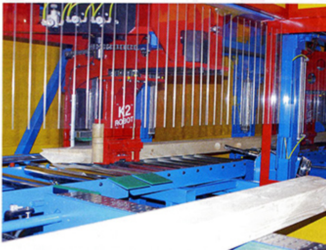
Verletzungsfreie Bearbeitung: Die Werkstücke führen gummierte Einziegreifer
