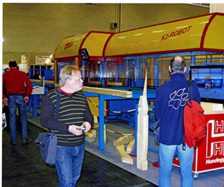
Die K2-Robot ermöglicht flexibles Arbeiten an allen sechs Produktseiten
