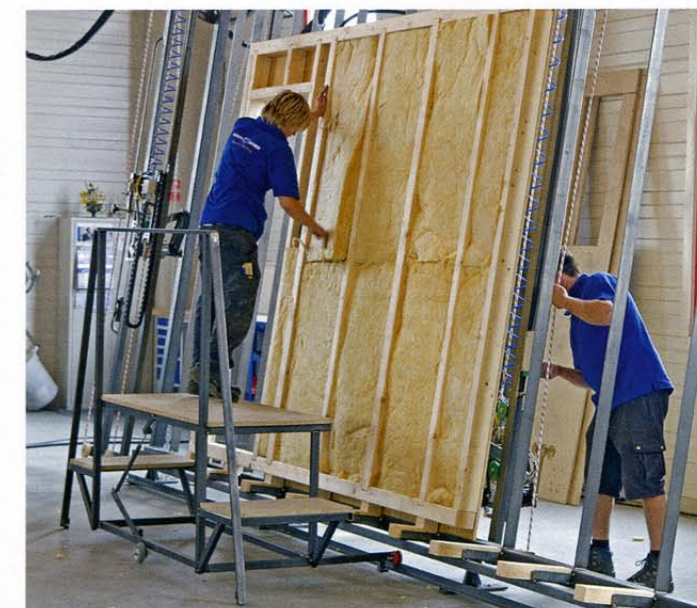
Gleichzeitige Wandmontage durch zwei Personen am Montagepult von Hundegger
